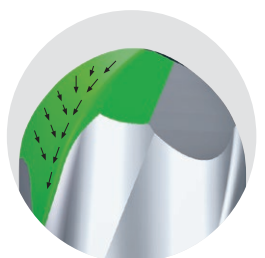
Representação CAD do design do espaço dos fios de corte
