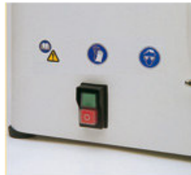
Interruptor de seguridad. Ante una falta de suministro eléctrico desconecta la RH3 teniéndose que rearmar manualmente (evitando arranques incontrolados).
