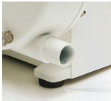
Sistema de desagüe lateral superdimensionado. El agua con el yeso son expulsados al exterior por las turbulencias de aire producidas por la muela.
