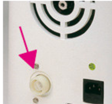
Electroválvula, que al accionar el interruptor general permite la entrada automática del agua a la máquina.
